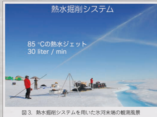
図3. 熱水掘削システムを用いた氷河末端の観測風景
